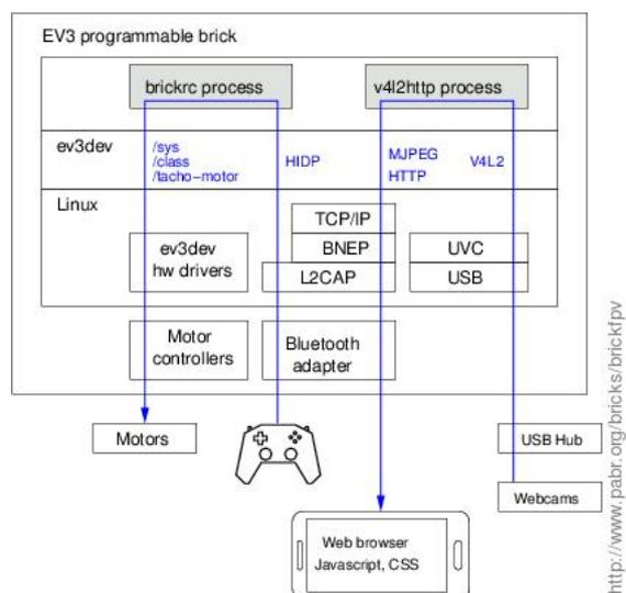
Dans l'implémentation actuelle un joystick Bluetooth se connecte directement à la brique EV3, et les flux vidéo MJPEG de caméras USB sont transmis également par Bluetooth (HTTP/TCP/IP/BNEP), en privilégiant la qualité d'image ou la vitesse de rafraîchissement selon les circonstances. Nous proposons plusieurs pistes pour améliorer la portée, la latence et la qualité vidéo.
