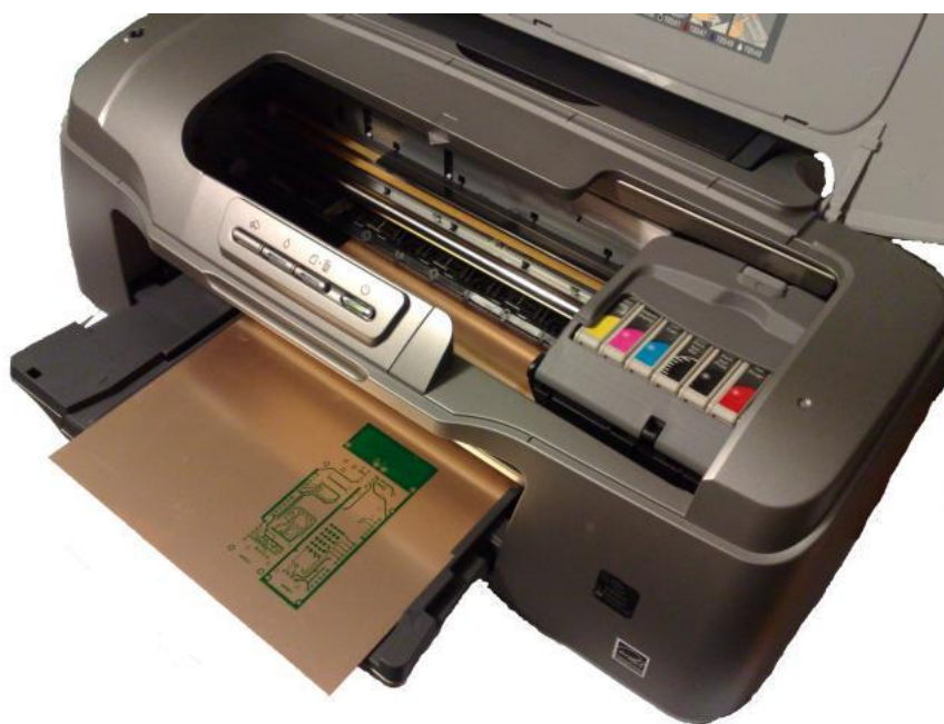
Figure 1. Epson R800 imprimant sur une plaque cuivrée de 200x300 mm.
