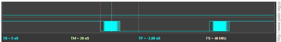
Figure 5. Impulsions de 20 \mu\text{s} générées par pxa_rtsched , avec une gigue de \pm 2 \mu\text{s}
