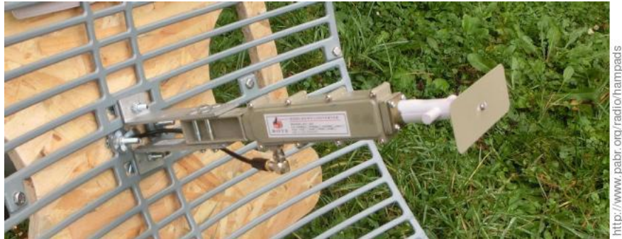
Figure 3. Tête MMDS fixée au réflecteur parabolique Wi-Fi.
