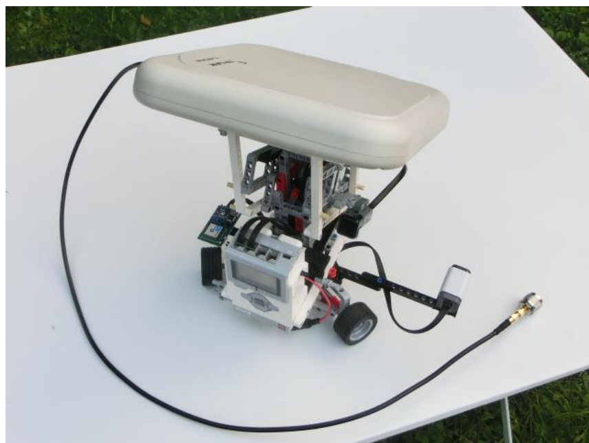
Figure 8. Rotor en LEGO pour satellites en orbite basse
