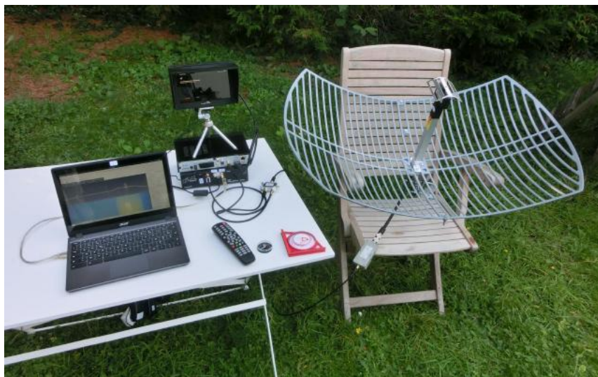
Figure 1. Configuration avec antenne fixe de 24 dB antenna
