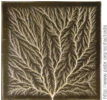
Ces objets décoratifs sont fabriqués dans des accélérateurs de particules. Des électrons relativistes pénètrent dans une plaque de Plexiglass épaisse, et une charge électrique considérable s'accumule à mi-profondeur. Le claquage se manifeste par une étincelle brève et intense qui laisse une trace permanente au cœur du matériau.
