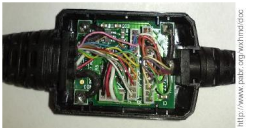
Figure 4. Platine cachée dans le cordon
